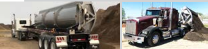
Yandan damperli yarı römorklar, yedeklemeye veya boşaltma için düz bir zemin bulmaya gerek kalmadan yumuşak veya engebeli zemine güvenli bir şekilde boşaltma yapıyorlar.
